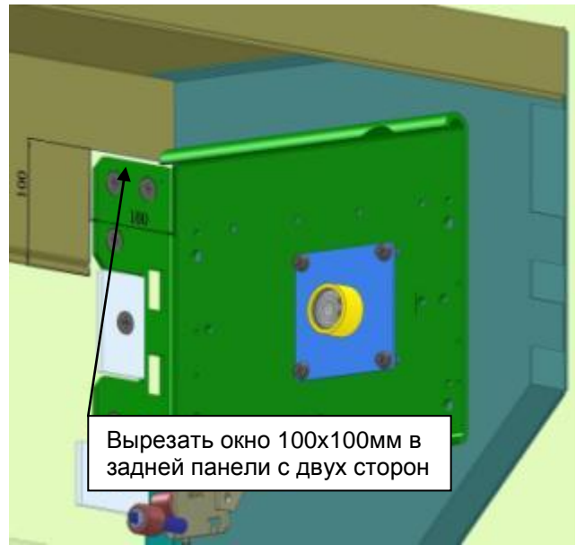
Рисунок 2.24-2.25. Установка задней панели корпуса
